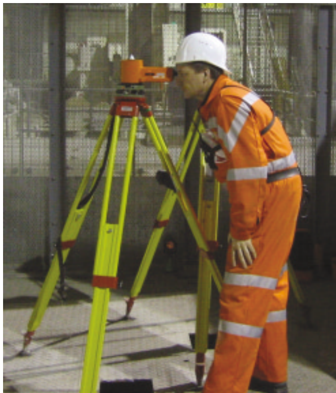
Figure 2. Lunette nadirale montée sur trépied
