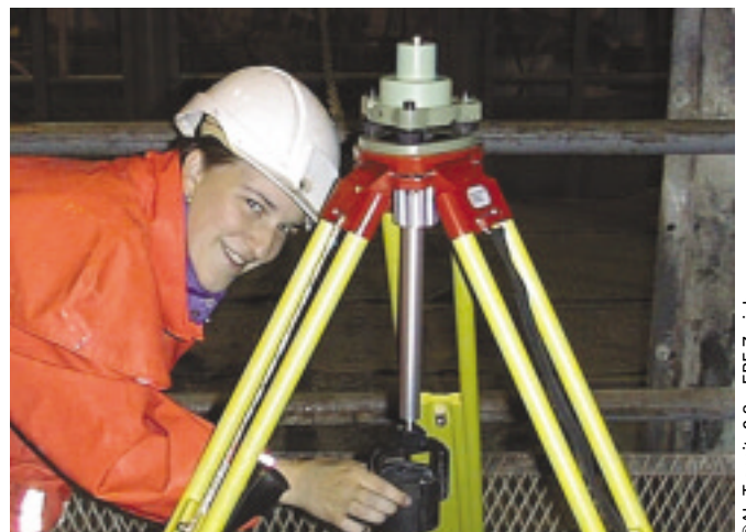
Figure 3. Réflecteur monté sous le trépied
