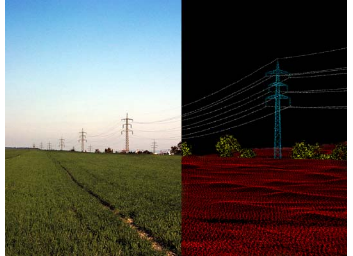
Abbildung 6: "Powerline Mapping" mit Laserscanning aus dem Helikopter.
