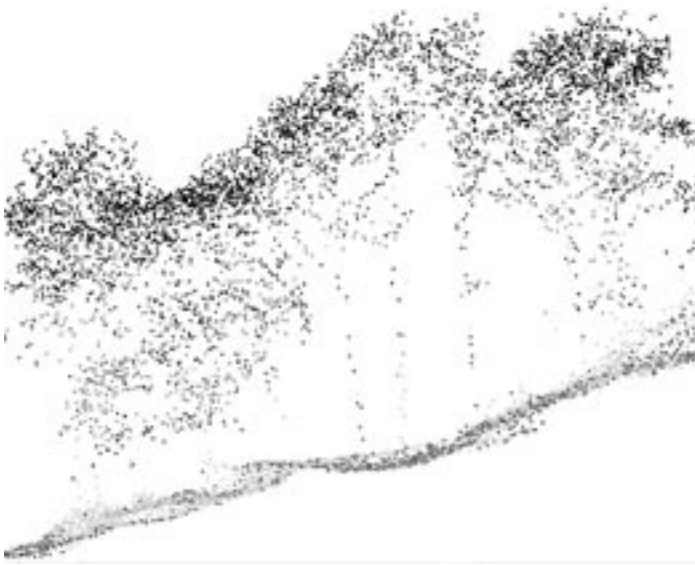
Abb. 5: Querschnitt durch die Messungen um eine Baumgruppe. Deutlich erkennbar die Baumstämme. In der Bildmitte ist das Profil eines Waldweges sichtbar.
